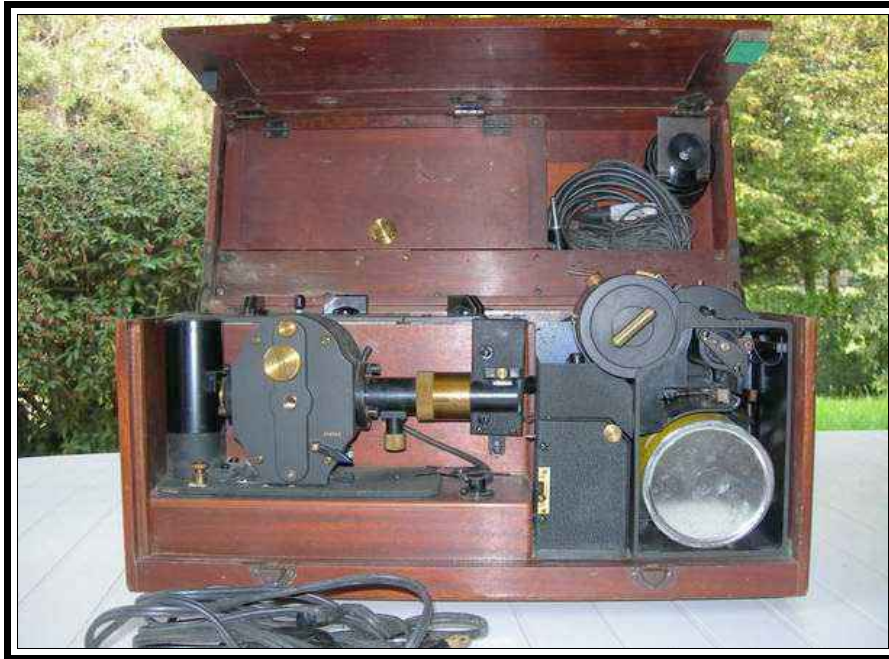
Simpli-Troll Cambridge Instruments Co. Uno dei primi elettrocardiografi "portatili"; il gavanometro è di tipo ottico ed il tracciato viene impresso su carta fotografica. 1935-40
