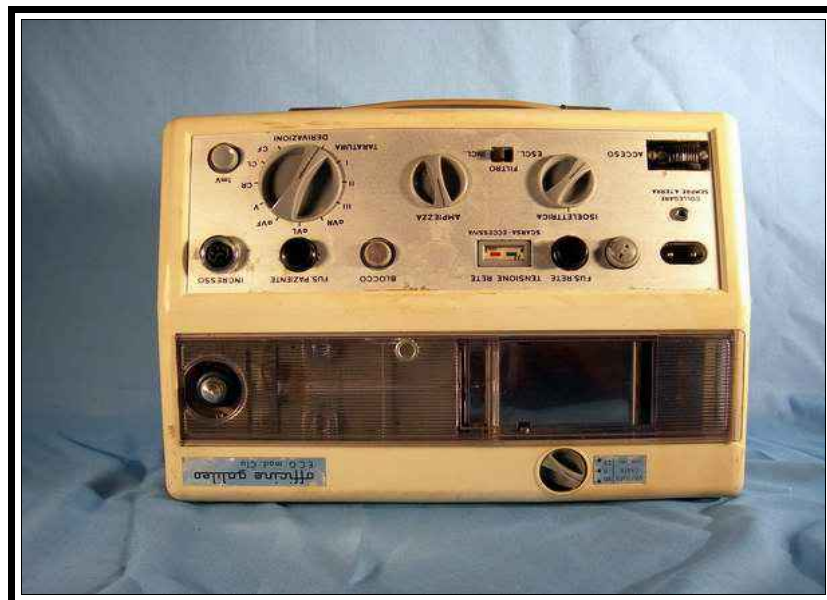
Officine Galileo Italia - monocanale a penna calda. Misto valvole-transistor.
